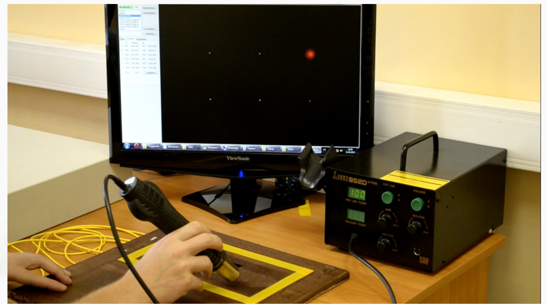
Температурное воздействие Красный цвет пятна соответствует нагреву, синий - охлаждению; размер пятна - интенсивности воздействия
